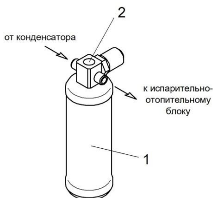
Рис.73. Ресивер системы кондиционирования
