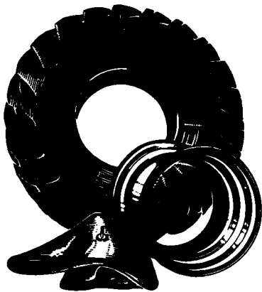
Рис. 102. Покрышка, камера и обод колеса трактора
