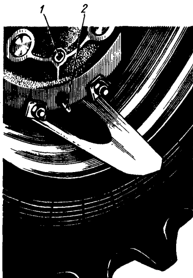
Рис. 96. Слив масла из конечной передачи
