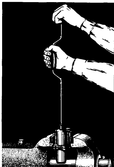
Рис. 108. Вращение регулировочной гайки регулятора давления
