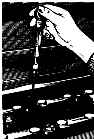
Рис. 113. Проверка плотности электролита
